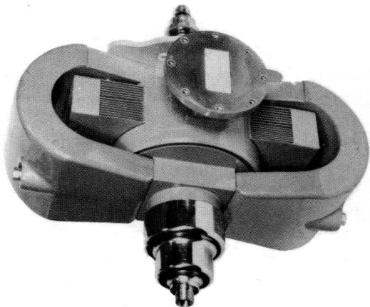
Grâce à son faible coefficient de poussée de fréquence, le TV 313 peut être utilisé avec des modulateurs fournissant des impulsions de formes très diverses, et de plus, le spectre obtenu est de bonne qualité.
