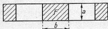
Fig. 334. Transformator met bruto kerndoorsnede F = ab en bruto oppervlakte O = pq van het wikkelvenster.
